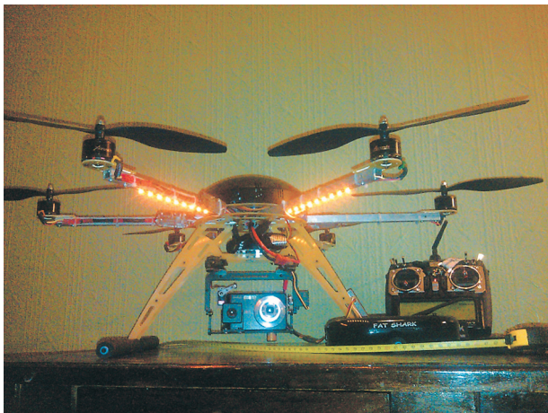
Рис. 9. Гексакоптер Xaircraft 650 (переработанная модель), видеоочки для полета Fat Shark, пульт управления Hitek 9 каналный (слева). Территория монастыря с квадратами съемки (справа). Фото Д. И. Жеребятъева
