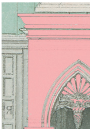
Рис. 1. Увеличенный фрагмент рисунка «фасад Чудова монастыря» с наложением чертежа портала
